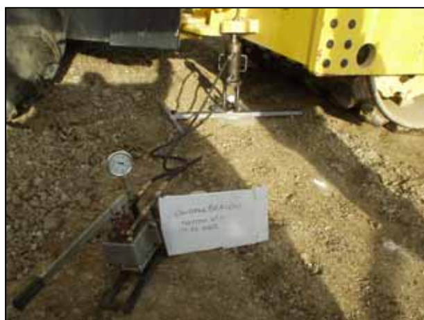
Prove di carico su piastra e di densità in sito sui terreni dopo la lavorazione.
