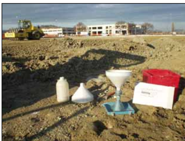
Prove di carico su piastra e di densità in sito sui terreni dopo la lavorazione.
